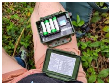
Illustration 3: installation d'un enregistreur passif Song Meter Mini Bat sur le terrain
