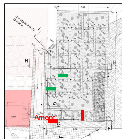
Figure 2 : Localisation des implantations des antennes à l'aval et au sein de la passe à poissons
